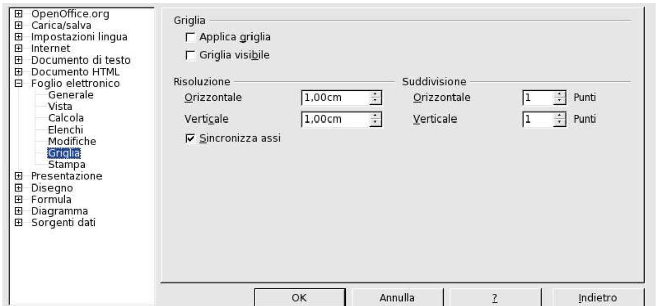
**Applica griglia** = Abilita lo spostamento di cornici, elementi di disegno e funzioni di formulario solo tra i punti della griglia. Per cambiare lo stato della griglia di cattura solo per una specifica operazione, trascinate un oggetto tenendo premuto il tasto (Ctrl)
